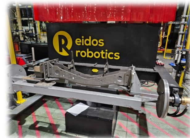
РТК сварки поперечин рам
