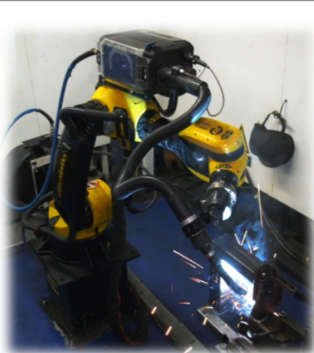
РТК сварки кронштейна гидрозамка кабины и др.
