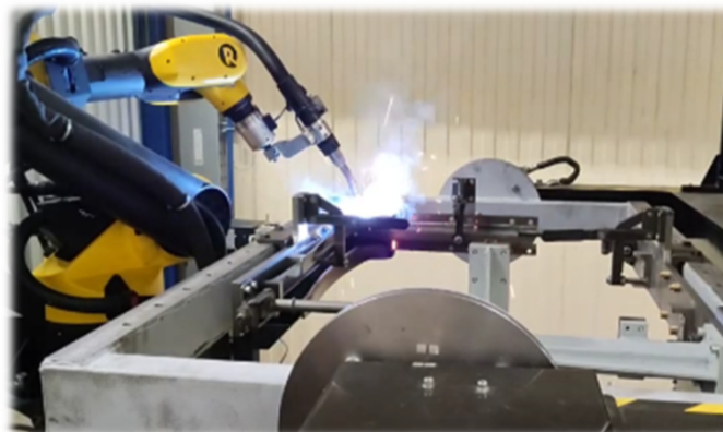
Сварка кронштейнов топливного бака
